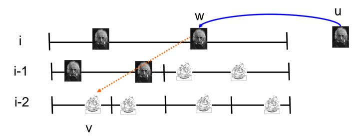
Man kann zeigen: w hat immer eine Kante zu einem Knoten in einem Intervall näher zu v. Durch diese "binäre Suche" kann v erreicht werden in logarithmischer Zeit (und geringer Congestion).
