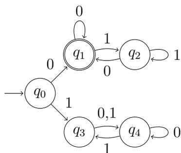
1. Übersetzen Sie die Grafik in eine extensionale Mengenschreibweise (Darstellung durch Auflistung) für  $Q$ ,  $\Sigma$ ,  $\delta$  und  $F$ .
