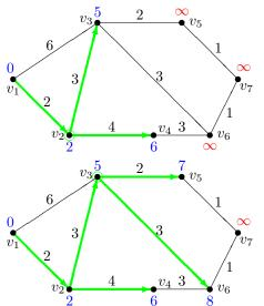
setze  $\operatorname{dis}[v_3]=2+3=5;$  markiere  $(v_2,v_3);$  unmarkiere  $(v_1,v_3);$  setze  $\operatorname{dis}[v_4]=2+4=6;$  markiere  $(v_2,v_4);$  setze  $v_3$  als Bezugsknoten, da  $\operatorname{dis}[v_3]$  minimal;
