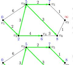
setze  $dis[v_5] = 5 + 2 = 7$ ; markiere  $(v_3, v_5)$ ; setze  $dis[v_6] = 5 + 3 = 8$ ; markiere  $(v_3, v_6)$ ; setze  $v_4$ , dann  $v_5$ als Bezugsknoten;
