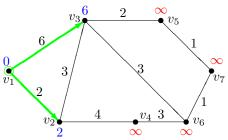
$$\begin{split} &\text{setze } \operatorname{dis}[v_2] = 2; \\ &\text{markiere } (v_1, v_2); \\ &\text{setze } \operatorname{dis}[v_3] = 6; \\ &\text{markiere } (v_1, v_3); \\ &\text{setze } v_2 \text{ als Bezugsknoten,} \\ &\text{da} \operatorname{dis}[v_2] \text{ minimal;} \end{split}$$
