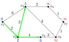
setze  $\operatorname{dis}[v_2]=2;$  markiere  $(v_1,v_2);$  setze  $\operatorname{dis}[v_3]=6;$  markiere  $(v_1,v_3);$  setze  $v_2$  als Bezugsknoten, da  $\operatorname{dis}[v_2]$  minimal;
