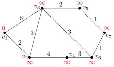
gegeben Graph G;  $v_1$  ist der Startknoten; setze  $v_1$  als Bezugsknoten; setze  $\mathrm{dis}[v_1]=0$ ; setze  $\mathrm{dis}[\mathrm{Rest}]=+\infty$ ;
